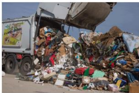
Extraction d'environ 10 % (carton, ferraille, bois) dans un centre de tri/transfert avant évacuation vers des filières de valorisation.
